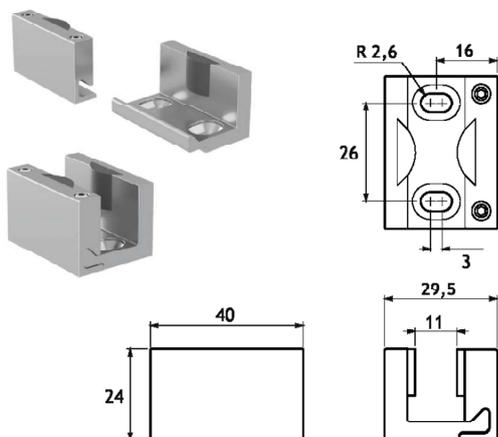
Guida a pavimento regolabile in due pezzi
